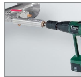
Vrtání pod tlakem s vrtacím přípravkem CS
